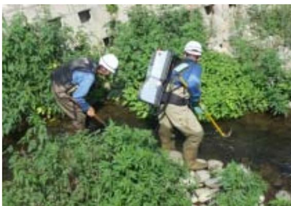
置を背負い、手持ちのロッドから電流を流し、魚類を一時的に気絶させて捕獲する方法です。電流を流すというと、魚類の密漁としてバッテリーを用いた漁法が知られており、悪いイメージを持っている方もいらっしゃると思いますが、エレクトロフィッシャーは電流、電圧、パルスを任意に調整できるため、魚を殺すことなく、効果的な捕獲が可能です。さらに、通常の網を用いた魚類調査では、魚が暴れて体表を傷つけてしまい、死に至るケースがよくありますが、エレクトロフィッシャーでは、捕獲時には魚は気絶しているため、傷つけることなく無傷での再放流が可能です。ただし、効果的な電流、電圧、パルスは環境により異なるため、状況に応じた設定を行う必要があります。
